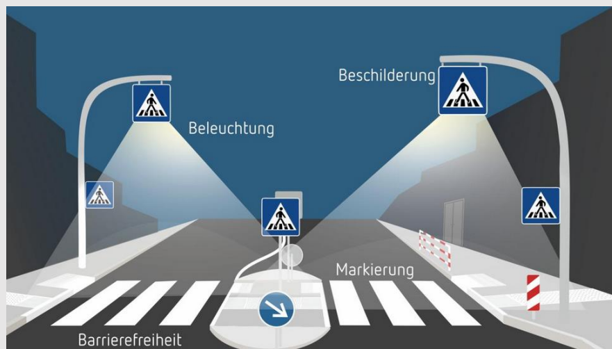
Idealtypisch ausgestatteter Fußgängerüberweg (Quelle Bild: Planersocietät)
