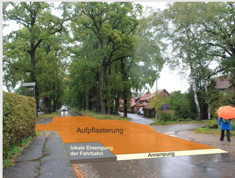
Einfache Skizze: Aufpflasterung und Anhebung der Fahrbahn im Kreuzungsbereich
